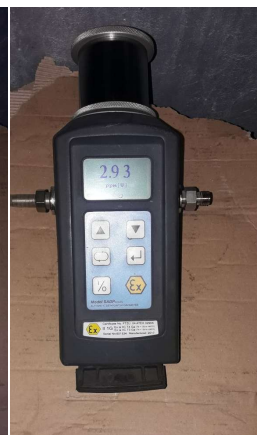
A gázellátó csővezeték nedvessége előtte és nedvesség mentesítés után
