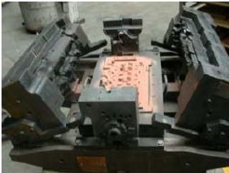
Gravitációs kokillaöntés (fém kokilla, homok magok)
