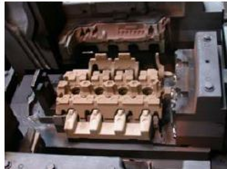
Gravitációs kokillaöntés (fém kokilla, homok magok)
