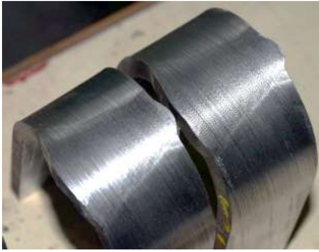
megfelelő próbatestek / proper welded joint
