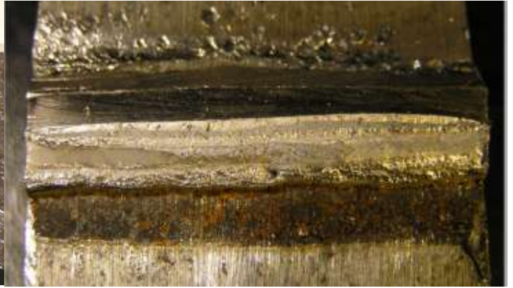
törtet felülete gázporozitással fracture surface with gas porosity
