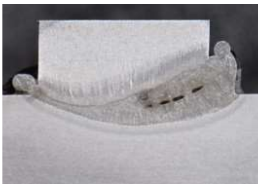
soros gázzárványok / row of gas pores
