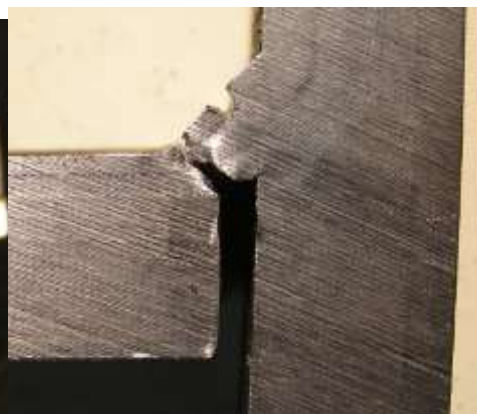
bemetszés a varratban a törethez notch in the weld for fracture test
