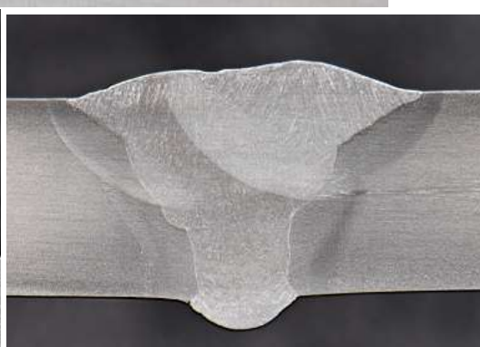
tökéletes makrók, hiba nélküli hegesztett kötések / perfect macros, defect-free welded joints
