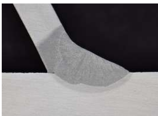
Maratási folyamat / etching
