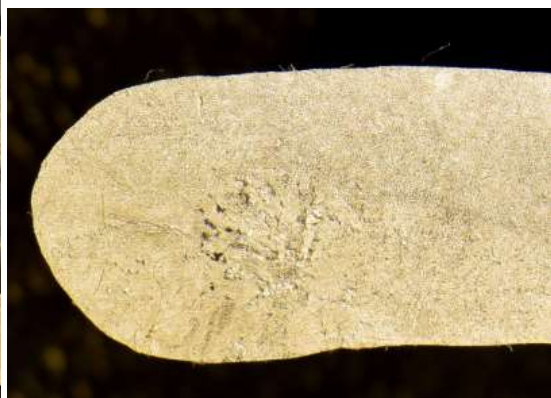
gázporozitás / gas porosity
