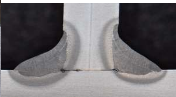
szegélykiolvadás és varratszimmetria eltérés undercut, shape and symmetry deviation
