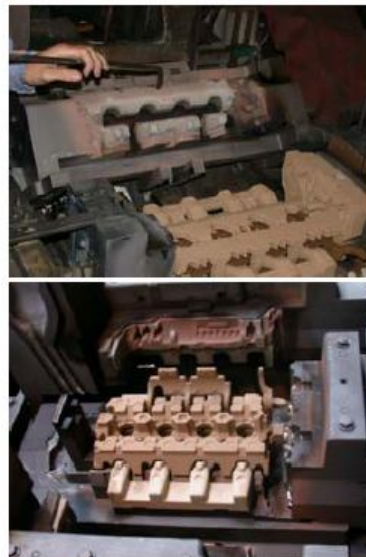
Gravitációs kokillaöntés (fém kokilla, homok magok)
