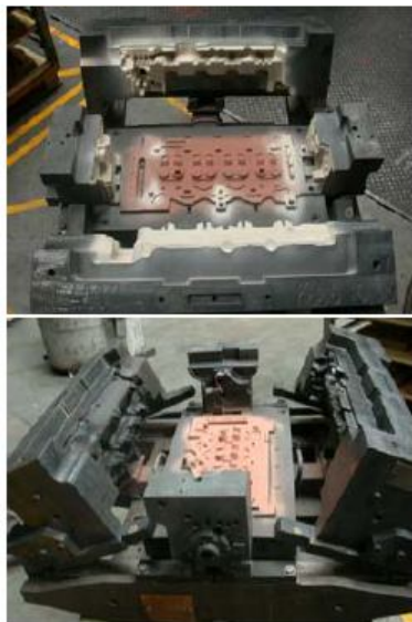
Gravitációs kokillaöntés (fém kokilla, homok magok)
